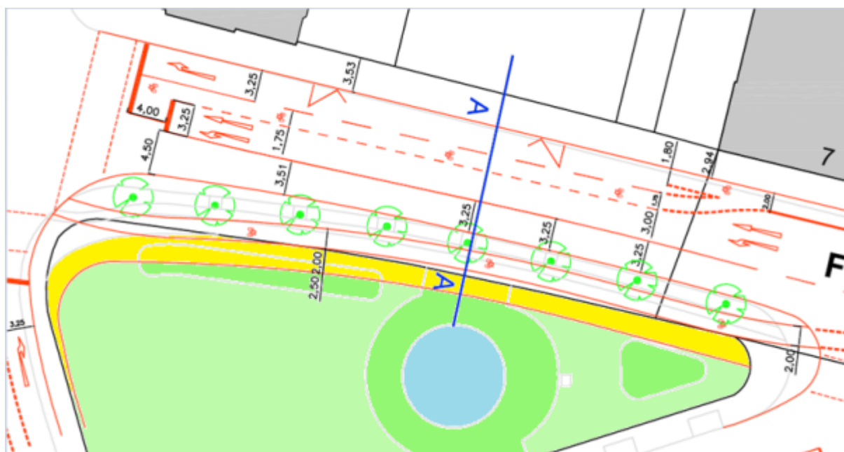
Abb.: Darstellung Variante 2 mit Eingriff in den Grünbereich des Schönleinsplatzes (in Gelb dargestellt)
