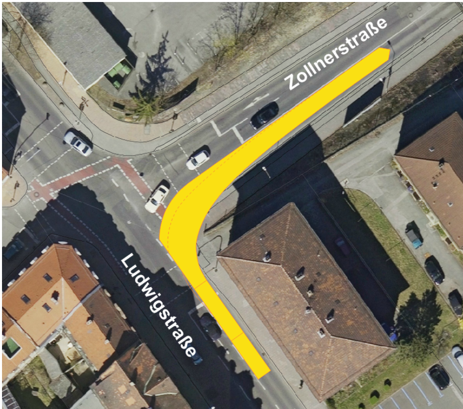
Abbildung: (Fahrkurve rechtsabbiegender Gelenkbus ohne Konflikt mit Fahrverkehr aus der Zollnerstraße bei Erhalt der Linksabbiegespur in der Zollnerstraße)
