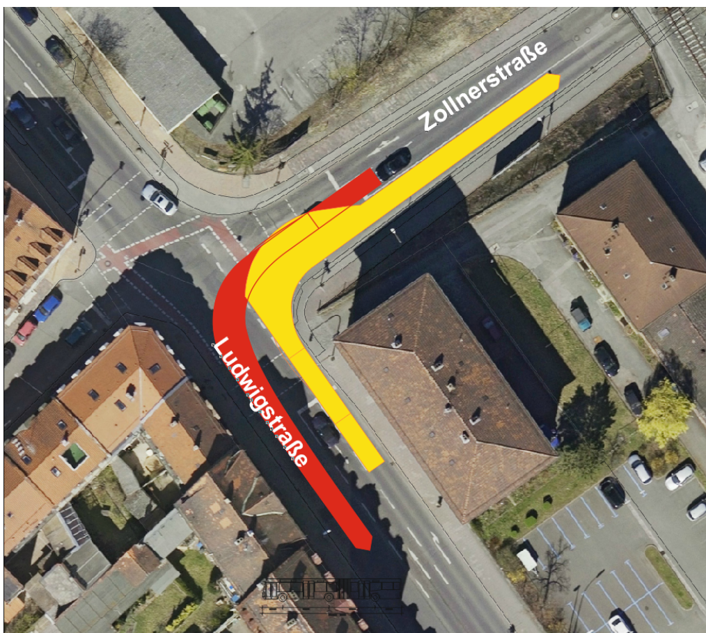
Abbildung: (gemeinsame Konfliktfläche zwischen Linksabbieger aus der Zollnerstraße und Rechtsabbieger aus der Ludwigstraße)
