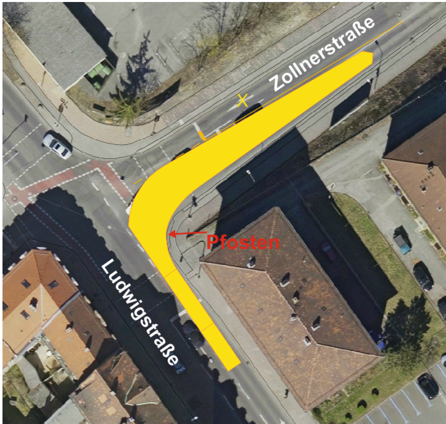
Abbildung: (Fahrkurve rechtsabbiegender Gelenkbus ohne Konflikt mit Fahrverkehr aus der Zollnerstraße)
