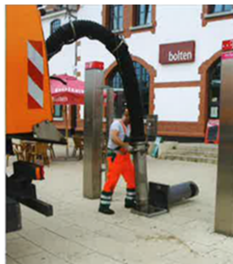
Absaugen eines Unterflurabfallcontainers mit einer Kehrmaschine mit Saugschlauch
