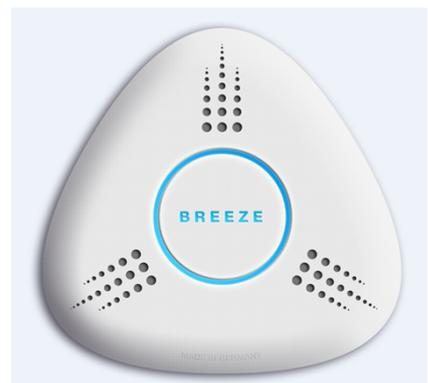
Ein zentrales Problem bei sämtlichen Analysen ist die Linearität der Messung. Aus den Angaben der Fa. Breeze geht diese Linearität nicht hervor. Für eine repräsentative Beprobung ist eine kontinuierliche, sowie kontrollierte Zuführung des Messgases an das Sensorelement entscheidend. Dazu ist eine aufwendige Messgasaufbereitung notwendig. Diese fehlt bei den Messgeräten gänzlich.
