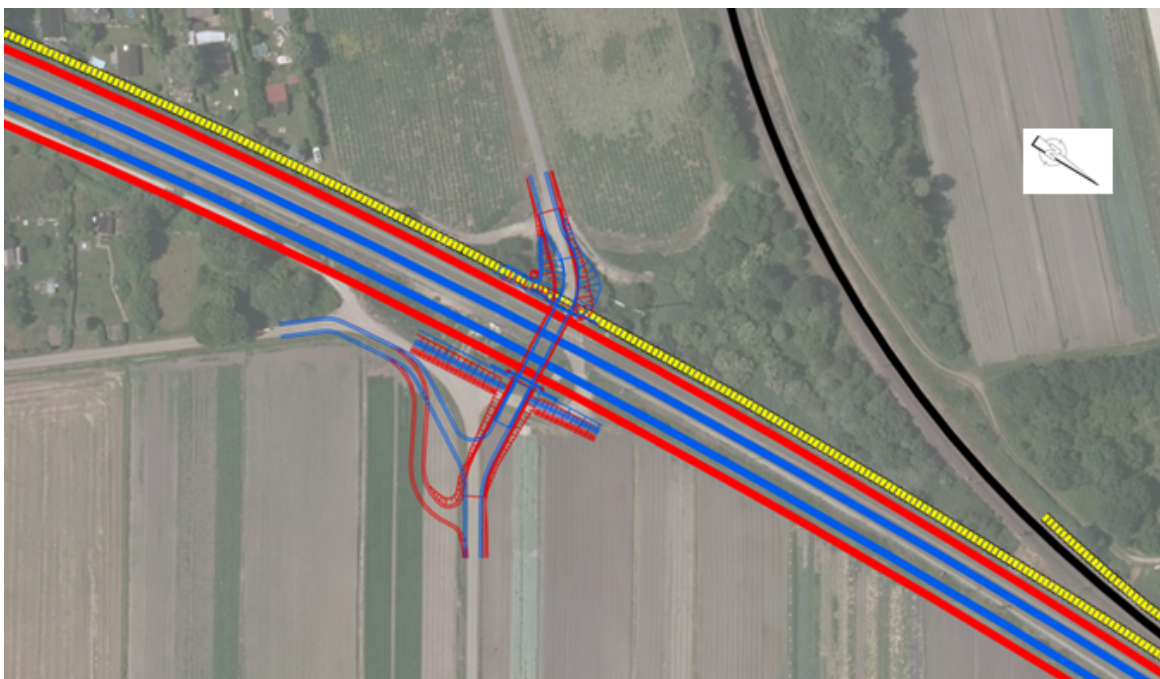
Var.1 Geh-/Radwegunterführung (blau) | Var. 2 Feuerwehraugliche Unterführung (rot)
