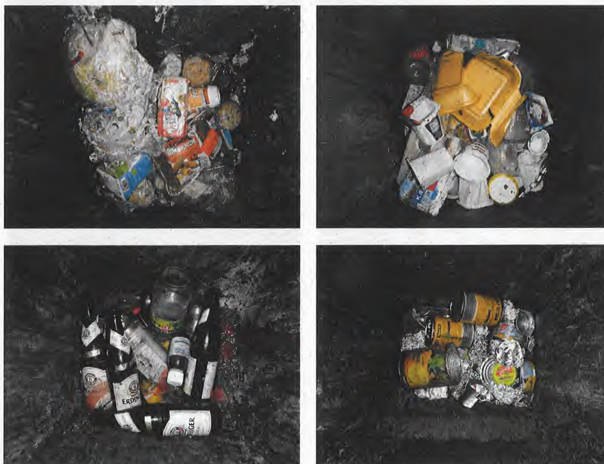
Abb. 8: Fremdstoffe im Bioabfall – jeweils aus einer Stichprobeneinheit aussortiert (oben links: verpackte Lebensmittel; oben rechts: sonstige Kunststoffe (hart); unten links: Glas; unten rechts: Metalle)
