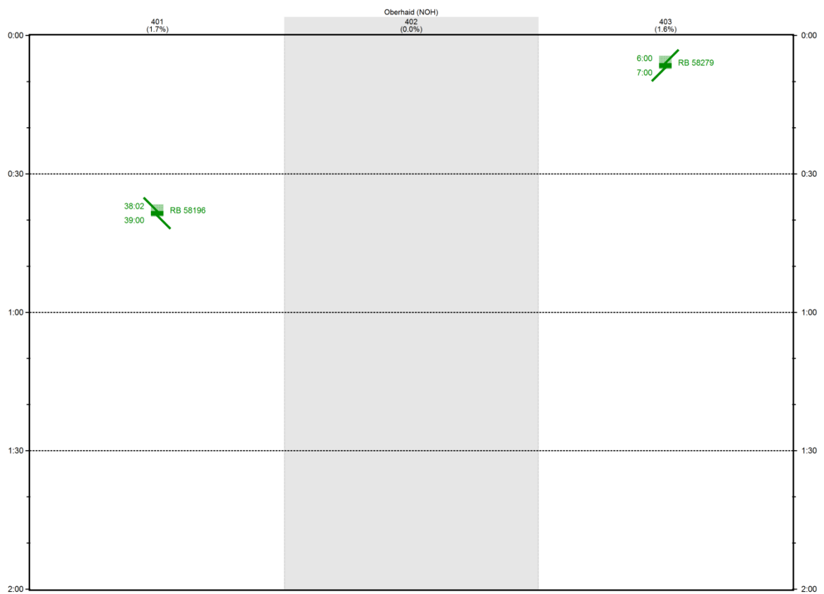
Abbildung 33: Gleisbelegung Oberhaid SVZ (0:00 - 2:00 Uhr).
