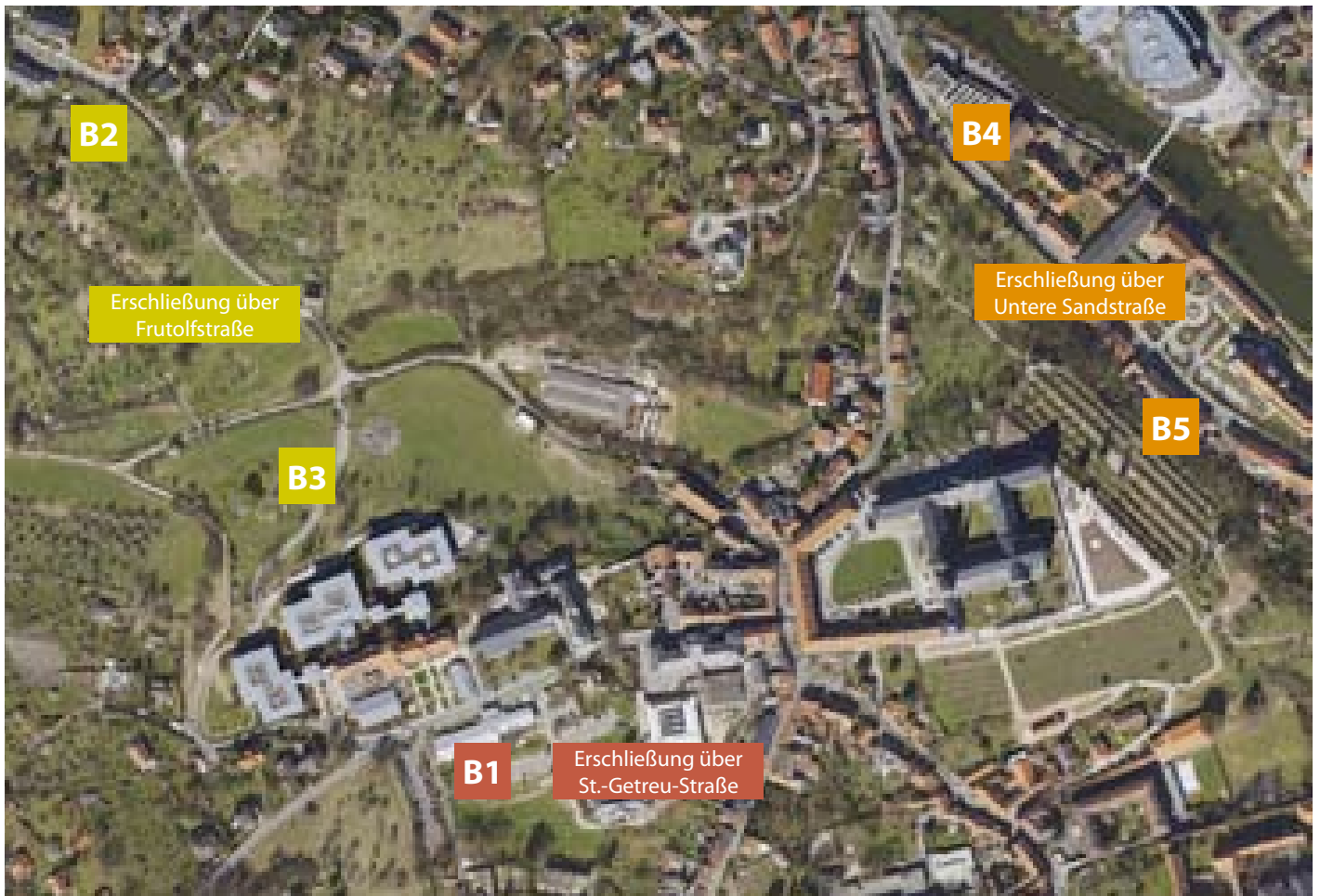
Abb. 8.13: Stellplatzanlagen in Abhängigkeit von der Erschließung
