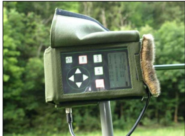
**Abbildung 3:** batcorder im stationären Einsatz (Auto – Timer – MODUS) am Gestänge (Foto: C. Strätz)
