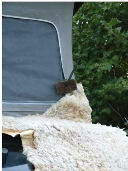
**Abbildung 4:** batcorder im stationären Einsatz (Auto – Timer – MODUS; BFC-Parkplatz) im Faltdach eines Reisemobils unter Einsatz Schall dämmender Maßnahmen (Fotos: C. Strätz)
